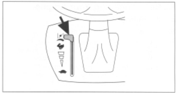
Rysunek 3. Regulator zespolony obrotów i ssania
